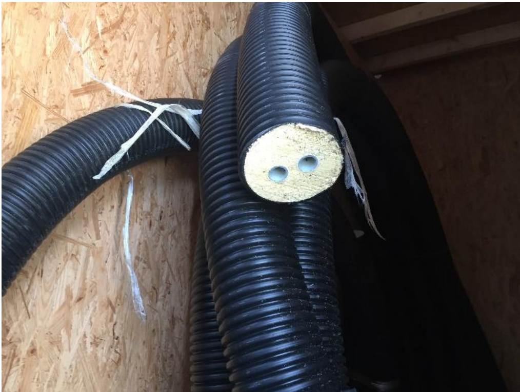
Pav. 6: Žemos temperatūros CŠT leidžia naudoti plastikinius vamzdžius, nuotraukoje pavaizduotas dvigubas plastikinis vamzdis kurio kaina ir įrengimo kaštai yra mažesni
