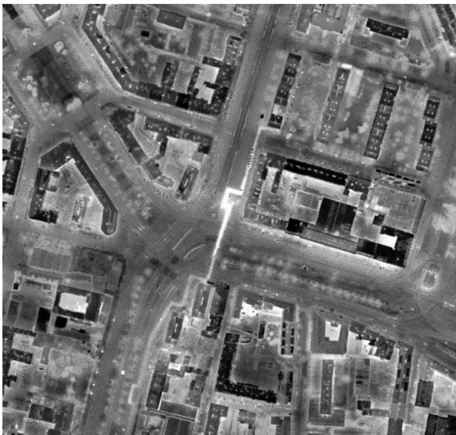
Slika 19: Termičko snimanje avionom (Izvor: SCANDAT GmbH)
