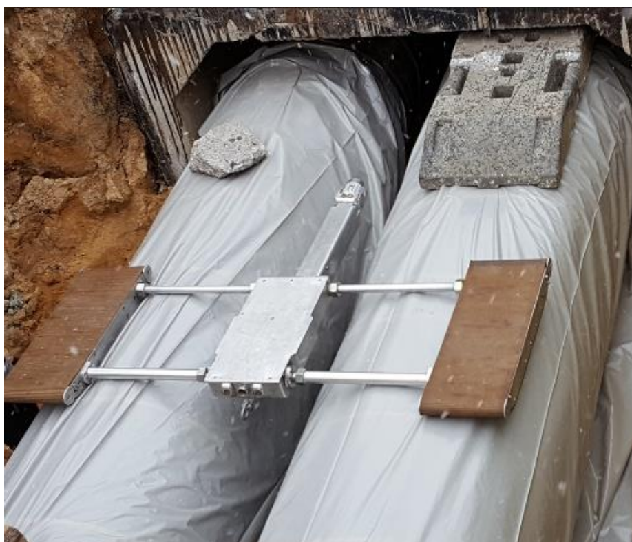
Slika 18 Vizuelna inspekcija "Crawler Eye" - Institut für Angewandte Bauforschung Weimar gGmbH (Izvor: AGFW)
