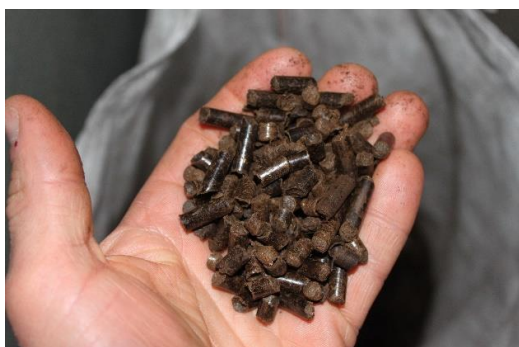
Slika 32: Tipične sirovine biomase za upotrebu u SDG: drvena sječka, peleti, toreficirani pelet, pirolitičko ulje (od gore lijevo do dole desno) (Izvori: D. Rutz)
