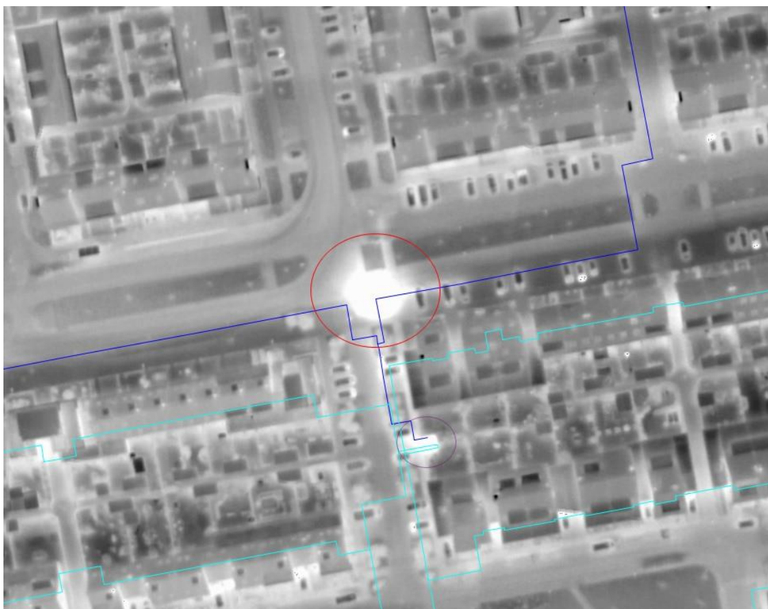
Slika 11: Termografsko snimanje mreže SDG koje pokazuje veliko curenje na cjevovodu (Izvor: COWI)
