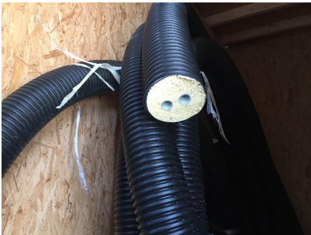
Figur 6: Lavtemperatur fjernvarme gør det muligt at bruge plastrør (her et twin rør), hvilket er mere kosteffektivt på grund af rørenes fleksibilitet der gør dem lettere at montere (Kilde: B. Doračić)
