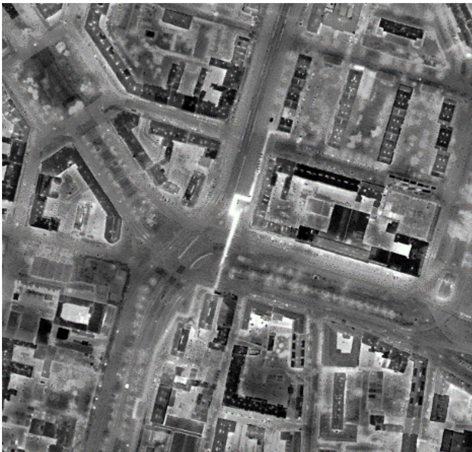
Figur 28: Termografering fra fly (kilde: SCANDAT GmbH)
