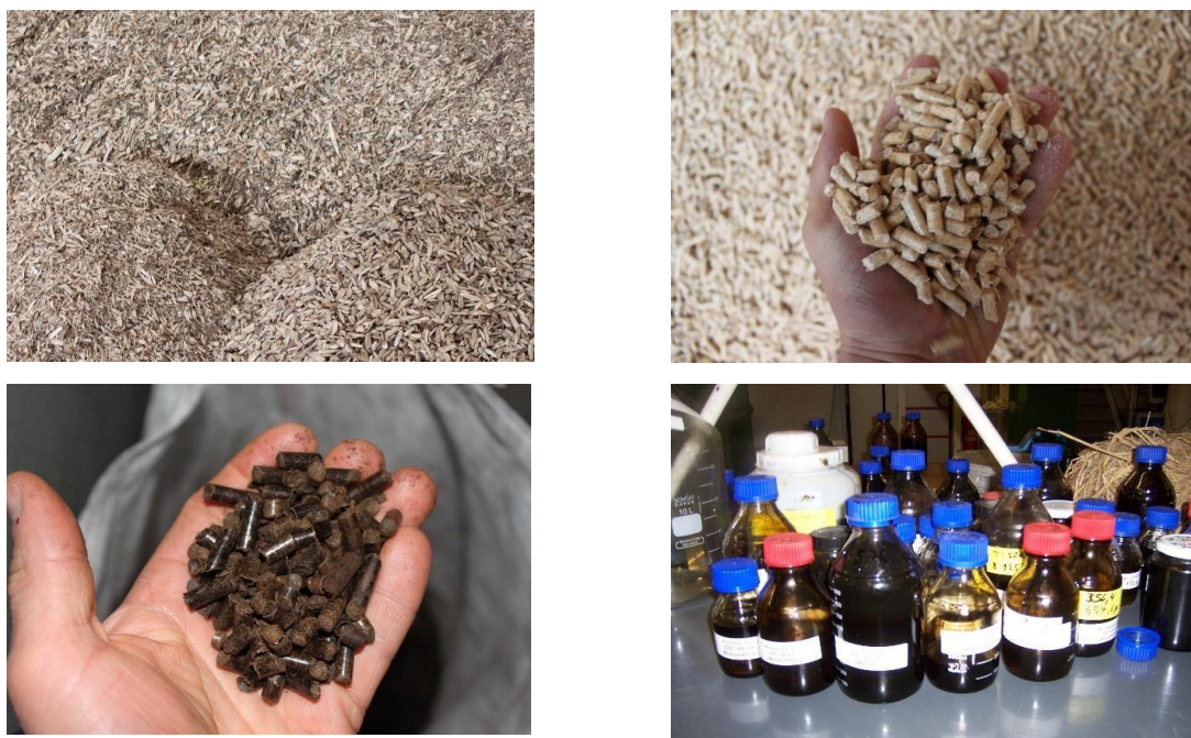
Figura 41: Materie prime comuni per la biomassa impiegata nel teleriscaldamento: cippato, pellet, pellet da torrefazione, olio da pirolisi (dall'alto a sinistra al basso a destra) (Fonti: D. Rutz)
