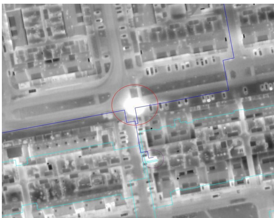
Figura 20: Immagini termiche di una rete di teleriscaldamento che evidenziano un'importante perdita da una tubatura (Fonte: COWI)
