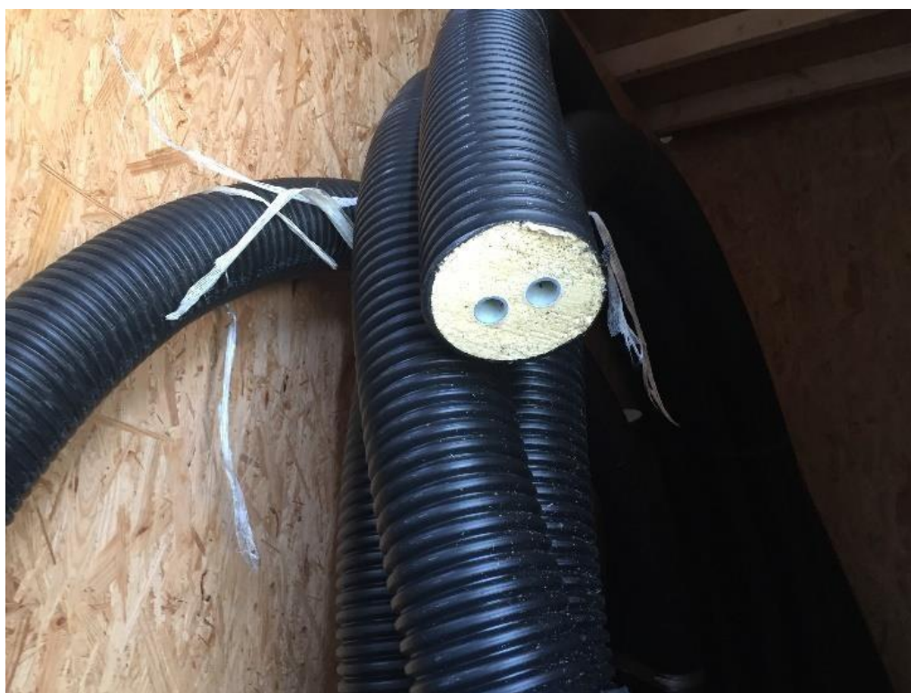
Figura 6: Il teleriscaldamento a bassa temperatura permette l'uso di tubature in plastica (si veda qui una tubatura binata), che hanno costi inferiori e risultano più semplici da montare, grazie alla loro flessibilità (Fonte: B. Doračić)
