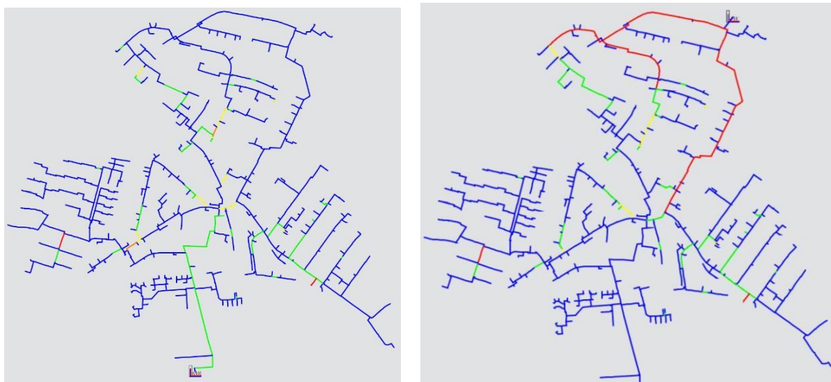
Figura 62: Screenshot TERMIS per l'aggiunta di una nuova centrale di generazione (Fonte: COWI)
